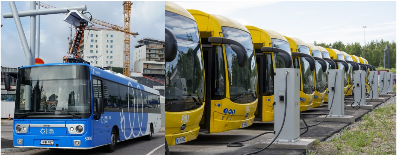
Kuva 4. Pysäkkilataus (vasemmalla) ja varikkolataus (oikealla). Kuvat: Linkker Oy ja Nobina Oy.
