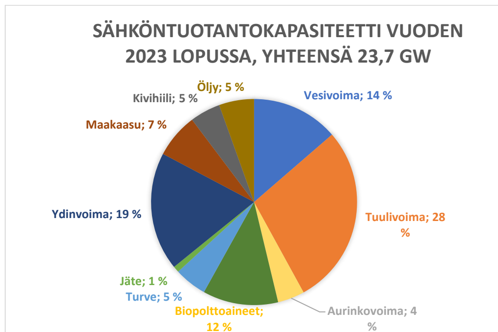
Kuva 6. Sähköntuotantokapasiteetti (asennettu nimellisteho, ei sisällä käyttövalmiudesta poistettua kapasiteettia) vuoden 2023 lopussa. (lähde: Energiavirasto)
